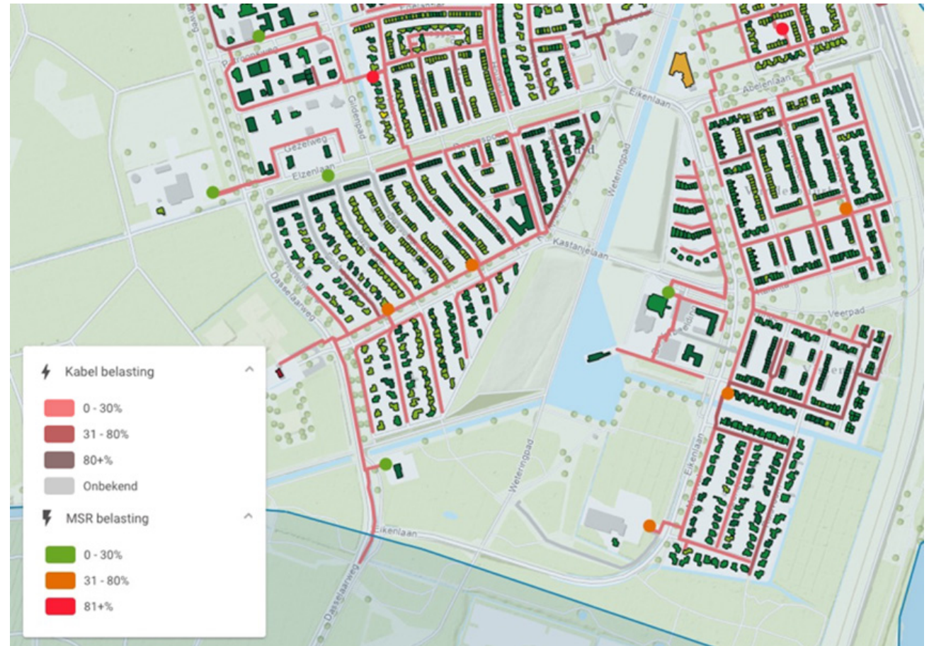
Figuur 2.5. De belasting van elektriciteitskabels (lijnen) en middenspanningsruimtes (bolletjes) in de drie buurten. Bron: Buurtanalysetool Liander.
